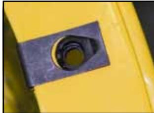
1. Take supplied clips and slide over rim of cyclone making sure flat part of clip is on the top and hole in clip is aligned with hole in cyclone rim. / Prenez clips fournis et glissez sur la jante du cyclone fait partie sûr plat de clip est sur le dessus et le trou dans l'agrafe est aligné avec le trou dans le cyclone jante.
