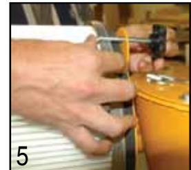
4. Plug hole in filter plate with the included plastic plug from inside of filter as shown. / Boucher le trou dans la plaque de filtre avec le bouchon en plastique inclus à l'intérieur du filtre comme indiqué.
