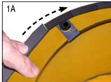
1A. Peel paper backing off of gasket material and attach to top of cone outside of clips as shown, making sure there is no gap in gasket where ends meet. / Papier Peel reculer de matériau d'étanchéité et fixer en haut de cône extérieur de clips comme indiqué, en s'assurant qu'il n'y ait pas d'espace dans le joint où les deux bouts.
