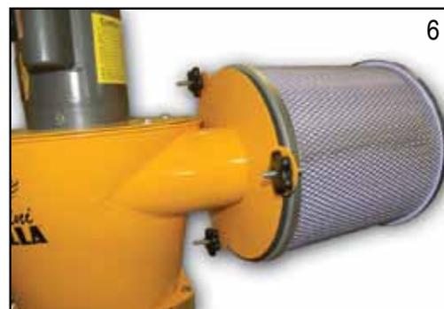
6. Attach filter to plate as shown using the (3) J - Hooks and Thumb Nuts. Make sure that rubber gasket is tightly and evenly compressed against the collector plate. / Fixez le filtre à l'assiette, comme indiqué en utilisant le (3) J - Crochets et Thumb noix. Assurez-vous que le joint en caoutchouc est bien et régulièrement comprimé contre la plaque de collecteur.
