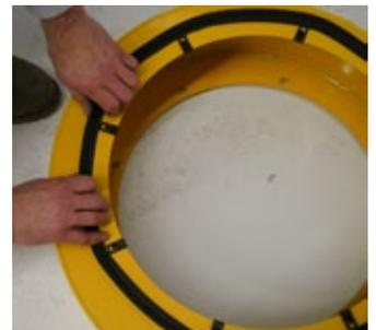
7. Attach U-Spring clips as shown on previous page to top of Fan Housing. Then apply gasket as shown, making sure the outlet is to your left as you look down as shown in diagram. / Fixez clips U-ressort comme indiqué sur la page précédente en haut du logement du ventilateur. Ensuite, appliquez le joint comme indiqué, en veillant à la sortie est à votre gauche quand vous regardez vers le bas comme indiqué sur le schéma.
