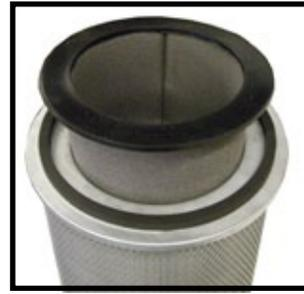
15. Pull Silencer out straight and place in top of filter, pushing it down into filter until top ring is flush with filter and fits snugly within the gasket. / Tirez Silencieux en ligne droite et place dans le top de filtre, poussant vers le bas dans le filtre jusqu'à ce que l'anneau supérieur est aligné avec filtre et s'adapte parfaitement dans le joint.
