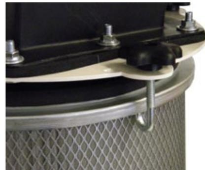
17. Hook J-hooks under metal rim of filter and evenly tighten, making sure filter's gasket is tightly sealed against filter plate. / Accrochez crochets en J sous jante métallique de filtre et serrer uniformément, ce qui rend le joint de vous que le filtre est bien étanche contre la plaque de filtre.
