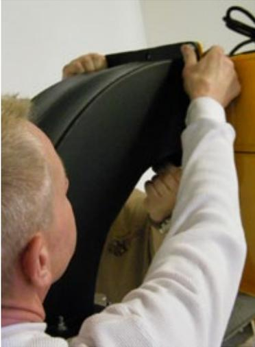
14 The (7) 3/8" hex head bolts and whiz nuts to attach the plenum are in the kit hardware. / Les (7) 3/8 boulons "à tête hexagonale et les écrous de prodiges pour fixer le plénum sont dans le matériel de la trousse.
