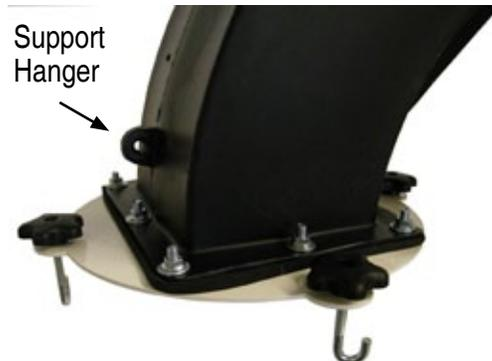
16. Put 4 J-hooks (AFJ051602) into filter plate as shown above and loosely tighten with thumb nuts (AFT000001). / Mettez 4 crochets en J (AFJ051602) dans la plaque de filtre comme indiqué ci-dessus et serrez légèrement avec écrous à oreilles (AFT000001).
