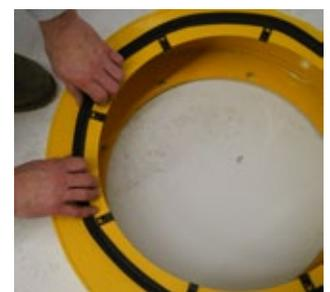
**5. Attach U-Spring clips (AFT051618) as shown on previous page to top of Fan Housing. Then apply gasket (RGZ000000) as shown, making sure the outlet is to your left as you look down as shown in diagram. / Fixez clips U-ressort (AFT051618) comme indiqué sur la page précédente en haut du logement du ventilateur. Ensuite, appliquez le joint comme (RGZ000000) indiqué, en veillant à la sortie est à votre gauche quand vous regardez vers le bas comme indiqué sur le schéma.**
