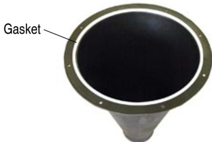
**2. Put included self-sticking gasket (RGZ000000) on top rim of cone inside of bolt holes.. Make sure there is NO gap where both ends of gasket meet. This is VERY important for an air tight seal. / Mettez inclus joint auto-collant (RGZ000000) sur le bord supérieur du cône intérieur de trous de boulons. Assurez-vous qu'il est PAS d'espace où les deux extrémités du joint se rencontrent. Ceci est très important pour l'étanchéité à l'air.**
