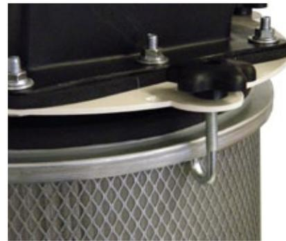
17. Hook J-hooks under metal rim of filter and evenly tighten, making sure filter's gasket is tightly sealed against filter plate. / Accrochez crochets en J sous jante métallique de filtre et serrez uniformément, ce qui rend le joint de vous que le filtre est bien étanche contre la plaque de filtre.
