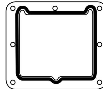
**12. Attach gasket (RGZ000000) to housing outlet, making sure there is no gap where ends meet. Go around dimple in bottom of outlet. You may have to trim out some gasket to ensure that the bolt holes are clear.** / *Fixez joint (RGZ000000) à la sortie du logement, en vous assurant qu'il n'ya pas de fossé où les deux bouts. Faites le tour de fossette au bas de la sortie. Vous pourriez avoir à couper certaines joint à veiller à ce que les trous de boulons sont claires.*
